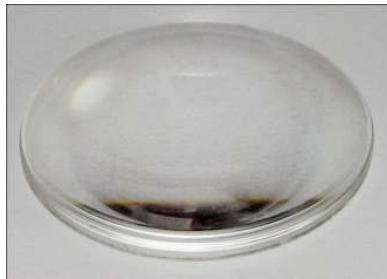
Rys 1 Soczewka utworzona przez powierzchnie kuliste
